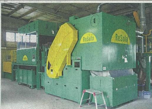
八幡リサイクルセンターに導入した「ReSola」5は、太陽光パネルの循環処理設備を整備して中間処理事業
